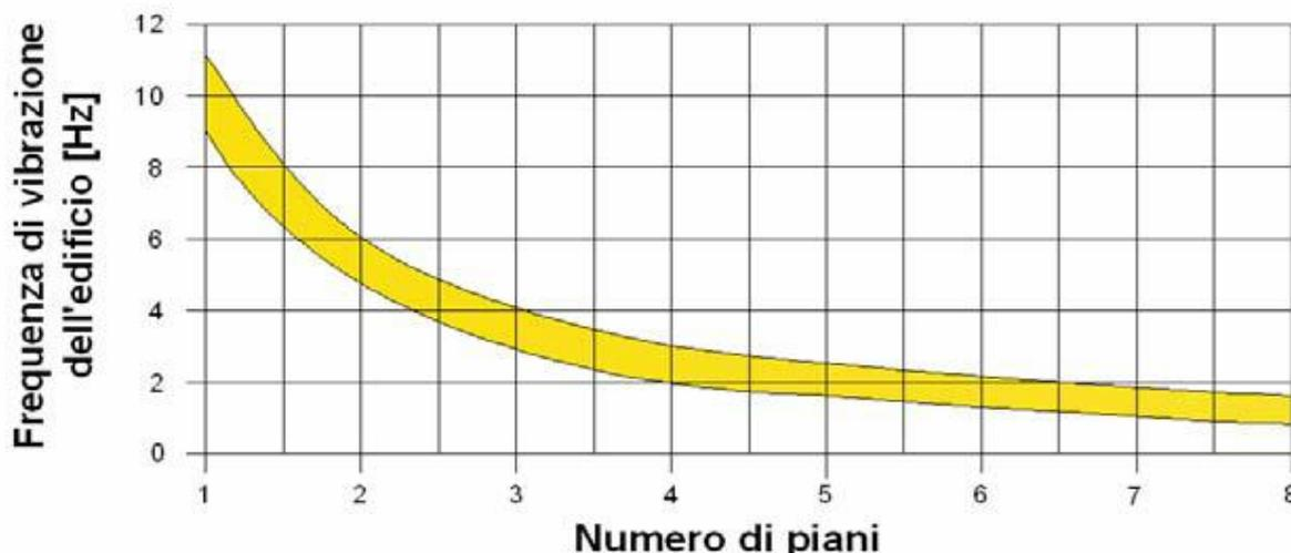
Dai risultati ottenuti si osserva che la frequenza di risonanza della struttura risulta superiore alla frequenza di risonanza del terreno (di sito).
